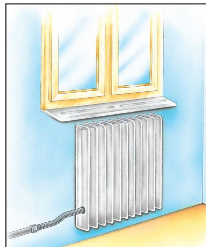
На этажных калориферах: у подключений горячей и холодной воды на панельных, чугунных и литых батареях.
